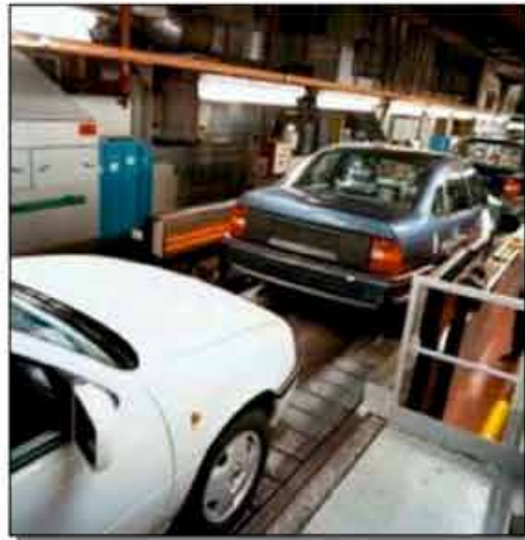
Riscaldamento delle zone in cui verranno applicate le modanature e riscaldamento delle modanature stesse
