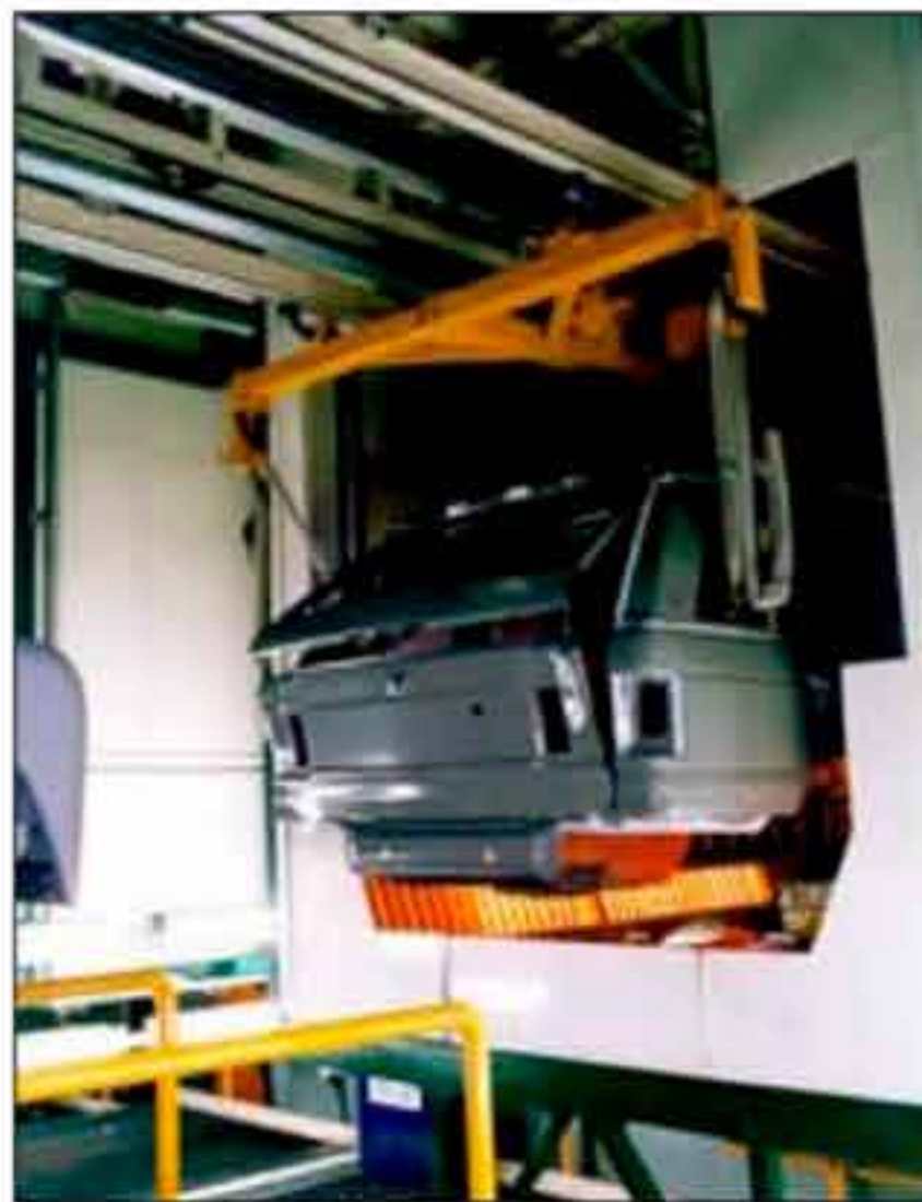
Trattamento di parti in PVC e sigillanti
