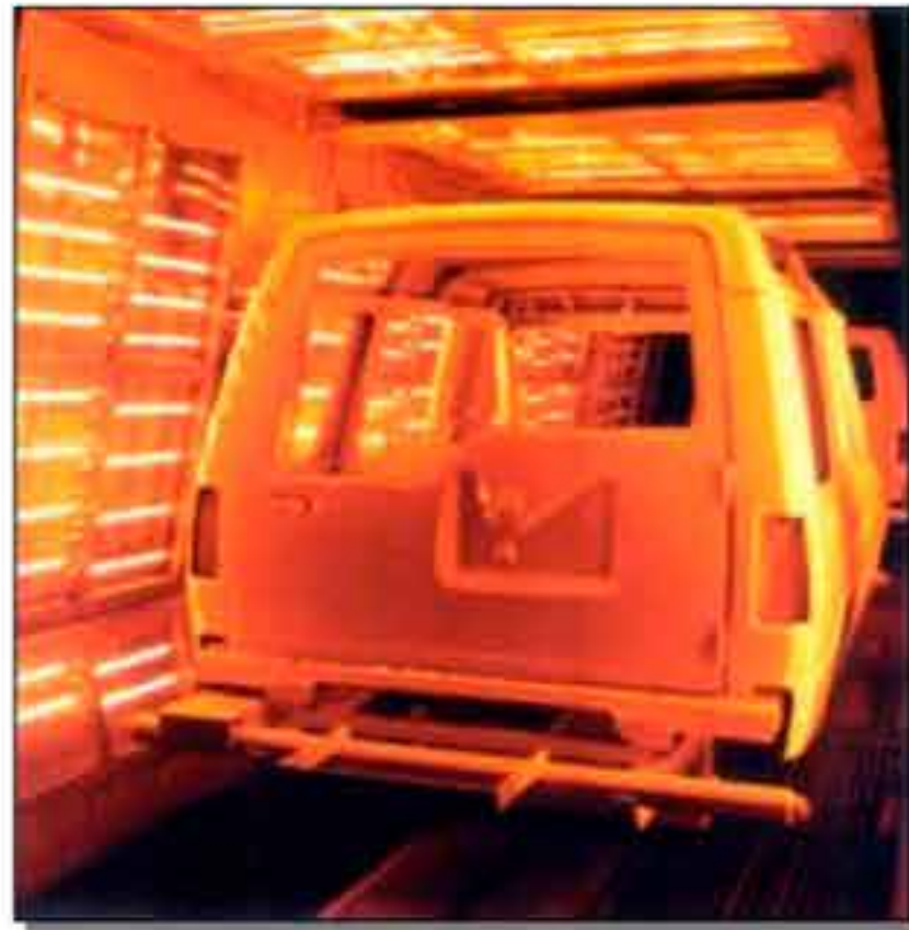
Essiccazione vernici a base d'acqua
