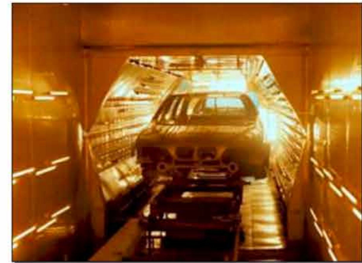
Essiccazione vernice trasparente
