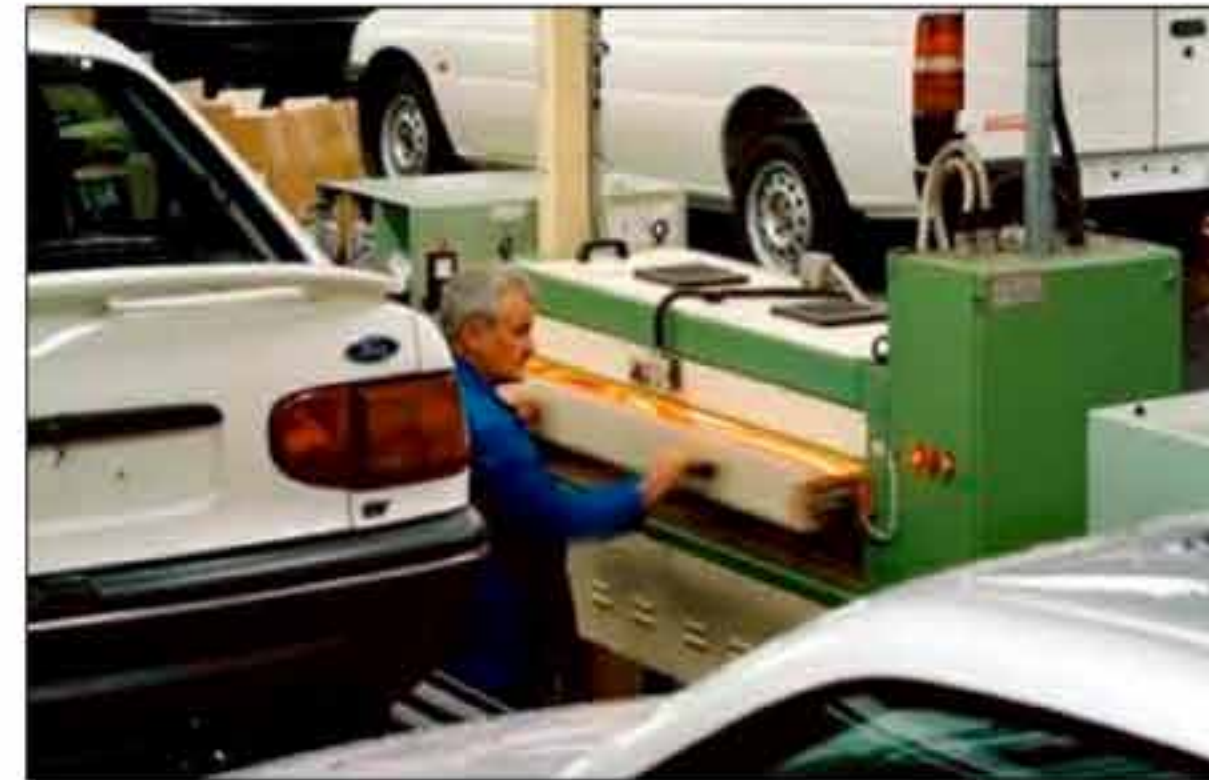
Riscaldamento delle zone in cui verranno applicate le modanature e riscaldamento delle modanature stesse
