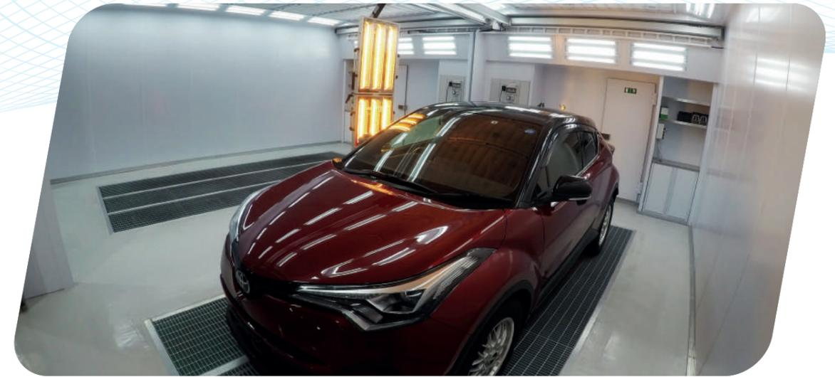
**Surya** è un innovativo sistema di essiccazione di prodotti vernicianti semiautomatico che utilizza la tecnologia dei raggi infrarossi garantendo una rapida essiccazione.
